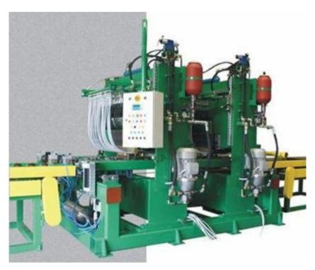
11. BS - двойная машина для рельефной контактной сварки тройников и панелей радиаторов
