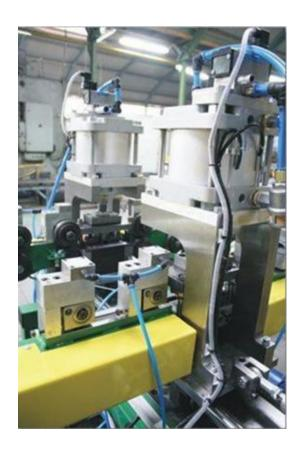
**9. Точечная контактная машина HS** для предварительной прихватки конвекционного листа к панели радиатора. Цена:........... Евро
