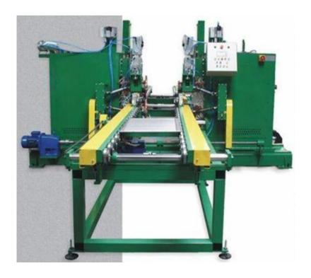
7. DQN – двойная машина контактной шовной сварки поперечных швов панелей радиаторов
