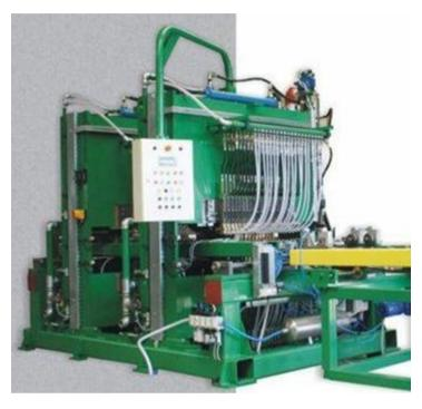
**6. DLN** — сдвоенная машина контактной шовной сварки продольных швов панелей радиаторов - размеры свариваемых панелей: ширина от 300 мм до 900 мм и длина от 400 мм до 3000мм - количество, шт.: 1
