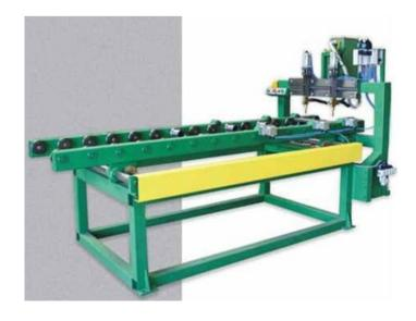
**5. DPVP** – двухрядная многоточечная машина контактной сварки панелей радиаторов с шагом подачи 33,3 мм
