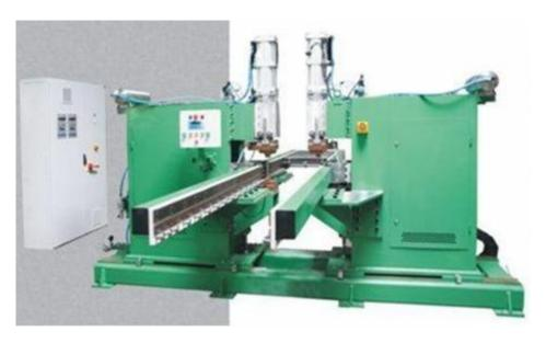
12. LS - Рельефная контактная сварочная машина для приварки скоб крепления радиаторов
