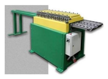
**8**. Установка для продольной гибки (отбортовки) верхних и боковых панелей для радиаторов тип 22. Цена, Евро: .....
