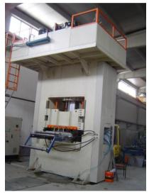
**4. Точечная контактная машина НЅ** для предварительной прихватки половин панелей радиаторов. Цена, Евро:.....
