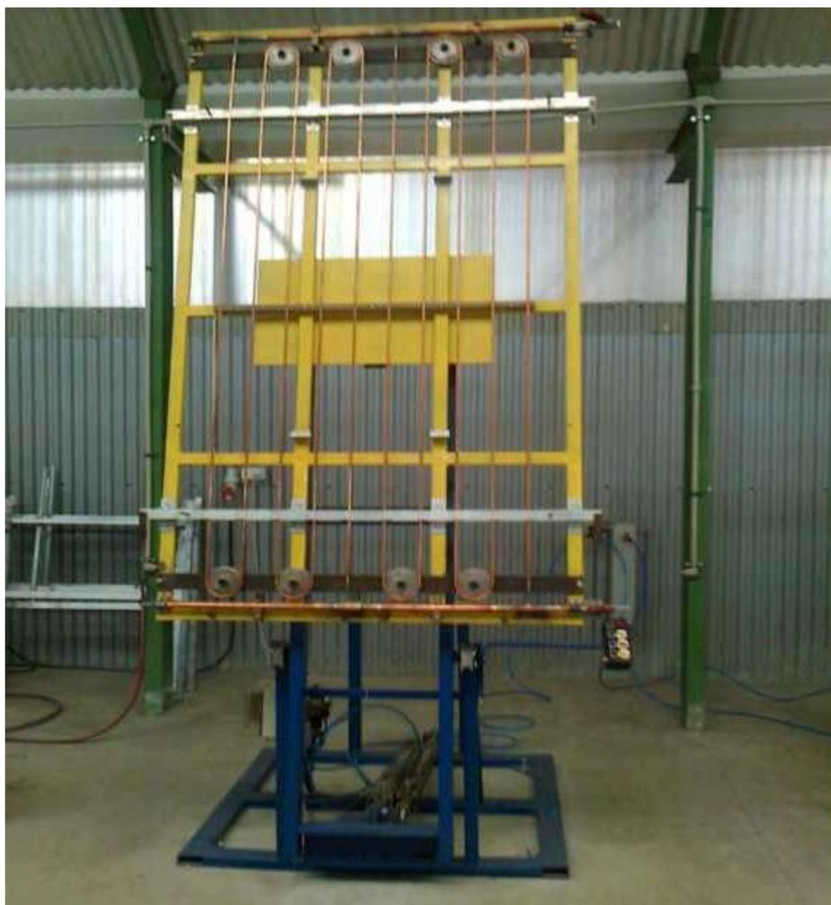
7. Устройство для очистки трубки абсорбера и проверки ее на герметичность
