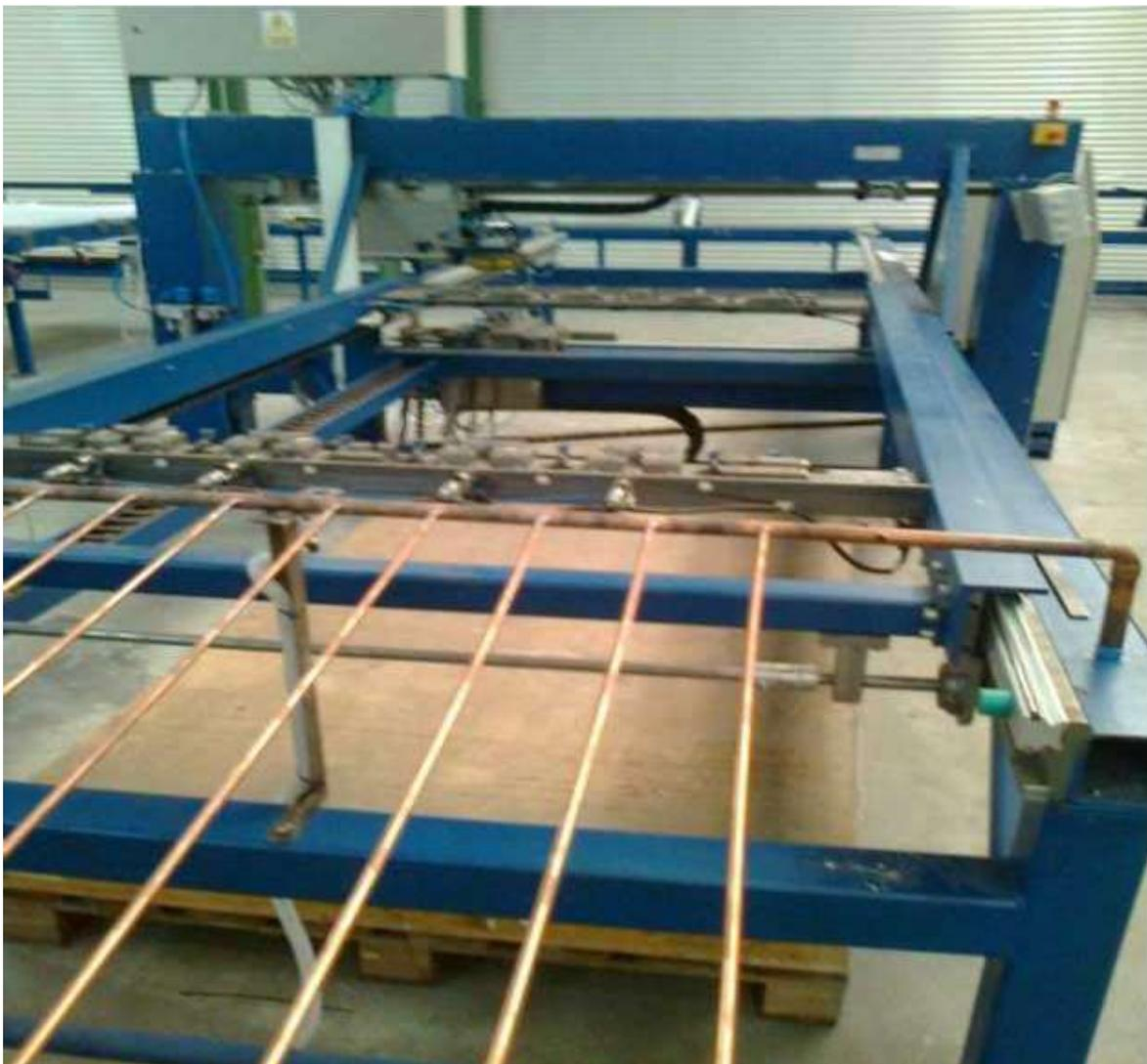
12. Стенд для проверки готового абсорбера
