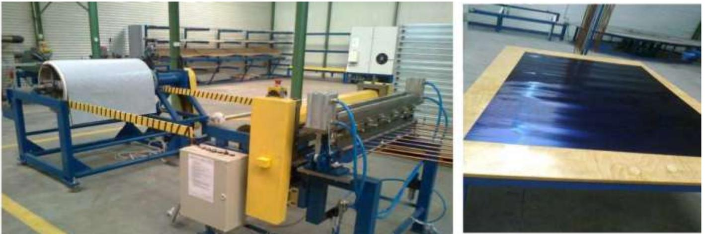
11.Ультразвуковая сварочная машина для абсорбера
